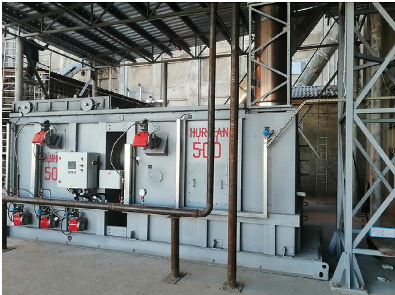
Давайте вместе немного подробнее поговорим о том, что же такое инсинераторы и что представляет из себя инсинерация отходов. Вообще, инсинератором можно назвать спецустановку, которая изготавливается для последующей переработки разных видов мусора. Переработка или утилизация осуществляется за счёт воздействия высоких температур. Также инсинератор очищает газы отходящие и защищает окружающую среду от негативных компонентов.
